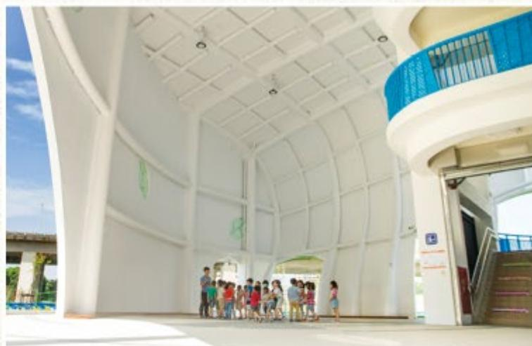
校門及穿堂設計，仿竹葉造型屋頂，種子多孔隙開口，複合式外牆造型版，配合校舍 Rc 斜屋頂版挑高，形成通風、隔熱、採光的綠建築也發展出校園天際線。
